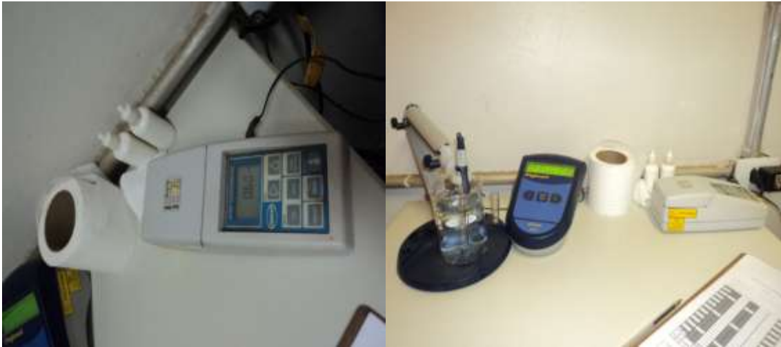
Figura 5: aparelhos para medir turbidez e PH da água. Fonte: Oliveira (2012).
